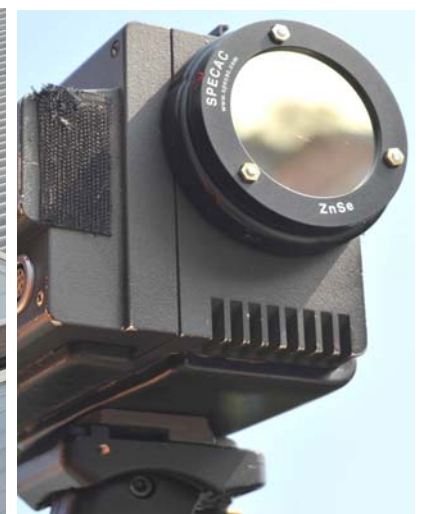
Zinkselenuid (ZnSe) IR-Polfilter in provisorischer Fassung
