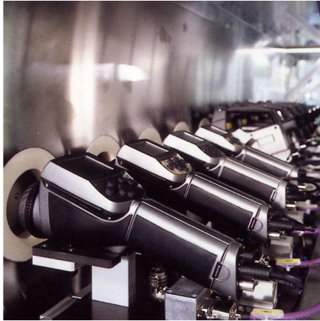
Abbildung 16.4 LINKS: Testen von Infrarotkameras in der Klimakammer; RECHTS: Roboter zum Testen und Kalibrieren von Kameras
