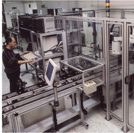
Abbildung 16.4 LINKS: Testen von Infrarotkameras in der Klimakammer; RECHTS: Roboter zum Testen und Kalibrieren von Kameras
