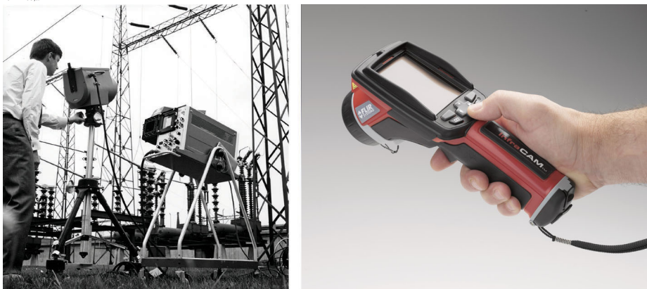
Abbildung 16.1 LINKS: Modell 661 der Thermovision® aus dem Jahr 1969. Die Kamera wog ca. 25 kg, das Oszilloskop 20 kg und das Stativ 15 kg. Für den Betrieb wurden darüber hinaus ein 220-Volt-Generator und ein 10-Liter-Gefäß mit flüssigem Stickstoff benötigt. Links neben dem Oszilloskop ist der Polaroid-Aufsatz (6 kg) zu erkennen. RECHTS: Die InfraCAM aus dem Jahr 2006. Gewicht: 550 g einschließlich Akku.
