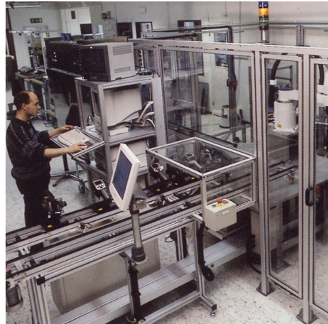
Abbildung 18.4 LINKS: Testen von Infrarotkameras in der Klimakammer; RECHTS: Roboter zum Testen und Kalibrieren von Kameras
