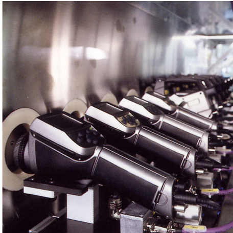
Abbildung 18.4 LINKS: Testen von Infrarotkameras in der Klimakammer; RECHTS: Roboter zum Testen und Kalibrieren von Kameras
