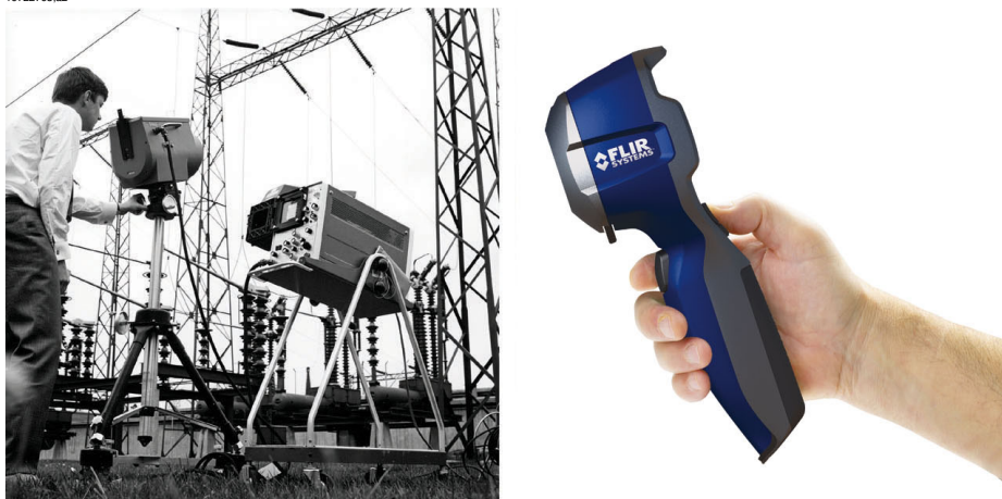
Abbildung 32.2 LINKS: Modell 661 der Thermovision® aus dem Jahr 1969. Die Kamera wog ca. 25 kg, das Oszilloskop 20 kg und das Stativ 15 kg. Für den Betrieb wurden darüber hinaus ein 220-Volt-Generator und ein 10-Liter-Gefäß mit flüssigem Stickstoff benötigt. Links neben dem Oszilloskop ist der Polaroid-Aufsatz (6 kg) zu erkennen. RECHTS: Die FLIR i7 aus dem Jahr 2009. Gewicht: 0,34 kg einschließlich Akku.
