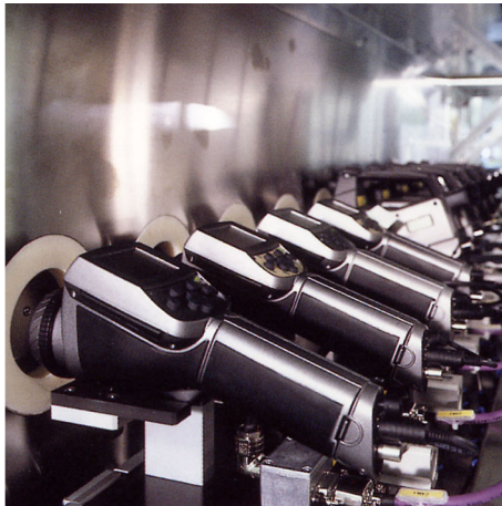
Abbildung 32.5 LINKS: Testen von Infrarotkameras in der Klimakammer; RECHTS: Roboter zum Testen und Kalibrieren von Kameras
