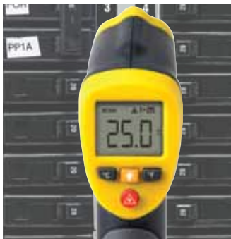
IR-Thermometer, Temperaturmessung an einem Punkt
