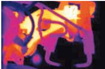
Heiße Stelle in einem Schweißroboter
