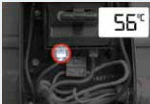
Das sieht ein IR-Thermometer.
