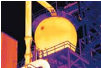
Untersuchung der feuerfesten Auskleidung in einem petrochemischen Reaktor
