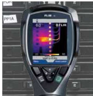
FLIR i3, Temperatur an 3600 Punkten
